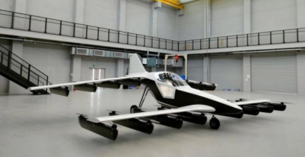
контроллера, которые в аварийной ситуации перераспределяют мощность по всем тридцати двум двигателям. Если уж водитель совсем зазеваётся и посадит все батарейки, обездвиженный самолёт опустится на землю с помощью стандартного баллистического парашюта.
