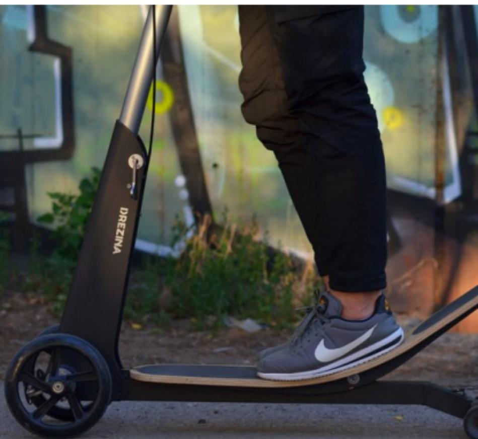
Drezina имеет алюминиевый корпус и полую стойку с регулятором высоты. Посередине горизонтального основания есть шарнир, на который крепится изогнутая доска из фанеры. Она соединена цепью с механизмом внутри стойки, который при каждом наклоне и подъёме доски преобразует это движение во вращение передних колёс.
